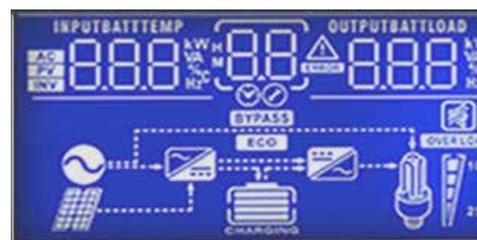
**Kann im tägl. Gebrauch mit Solarmodul voll autark die Energieversorgung übernehmen mit Netzaufschaltung wenn Solarenergie nicht ausreicht**
